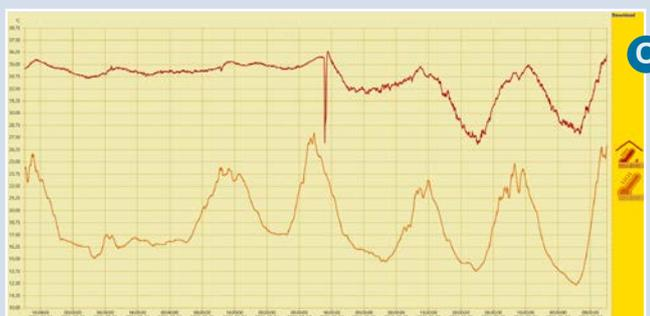
Diagramm: Stocktemperatur vs. Außentemperatur .
